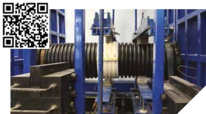
Prova di tenuta con giunto disassato
